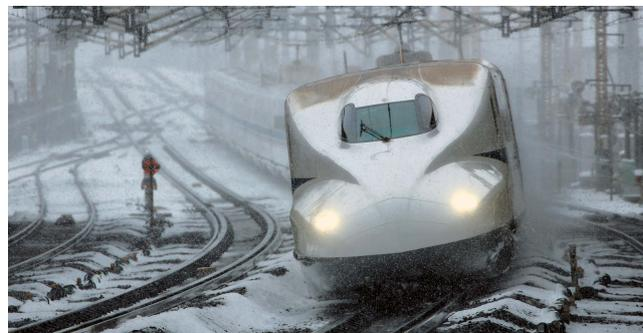
写真1 スプリンクラーで散水された線路上を走る新幹線車両
